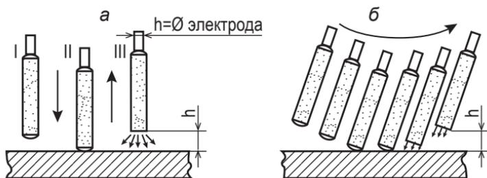
Рис. 6. Зажигание дуги:
