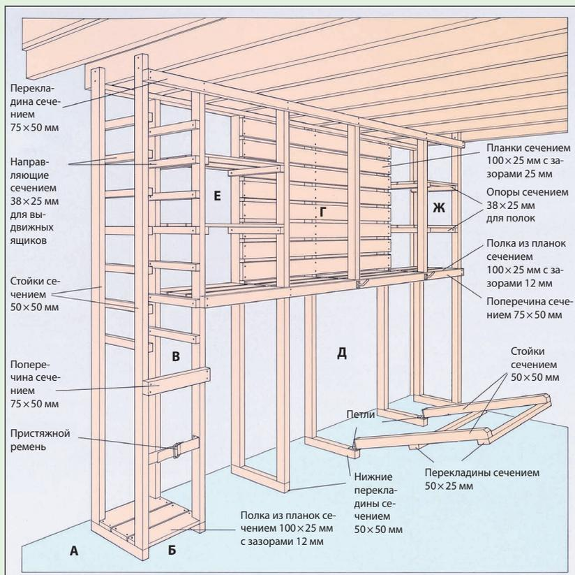
Гаражный стеллаж является универсальным приспособлением для хранения разнообразных вещей. Секция А высотой до потолка предназначена для хранения стремянок, досок, молдингов, медных или пластмассовых труб и тому подобных предметов.
