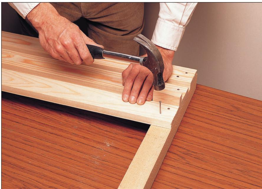
**5** Для изготовления стенного стенда набейте на раму планки. Чтобы зазоры между планками были одинаковыми, пользуйтесь
