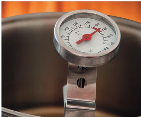
Перед использованием термометр необходимо проверить. Для этого прибор следует держать в кипящей воде 3 минуты. Если после этого он будет показывать температуру более 100 °С, то полученную разницу нужно прибавить к температуре, указанной в рецепте. Показатель может быть и ниже 100 °С. В этом случае разницу следует вычесть.
